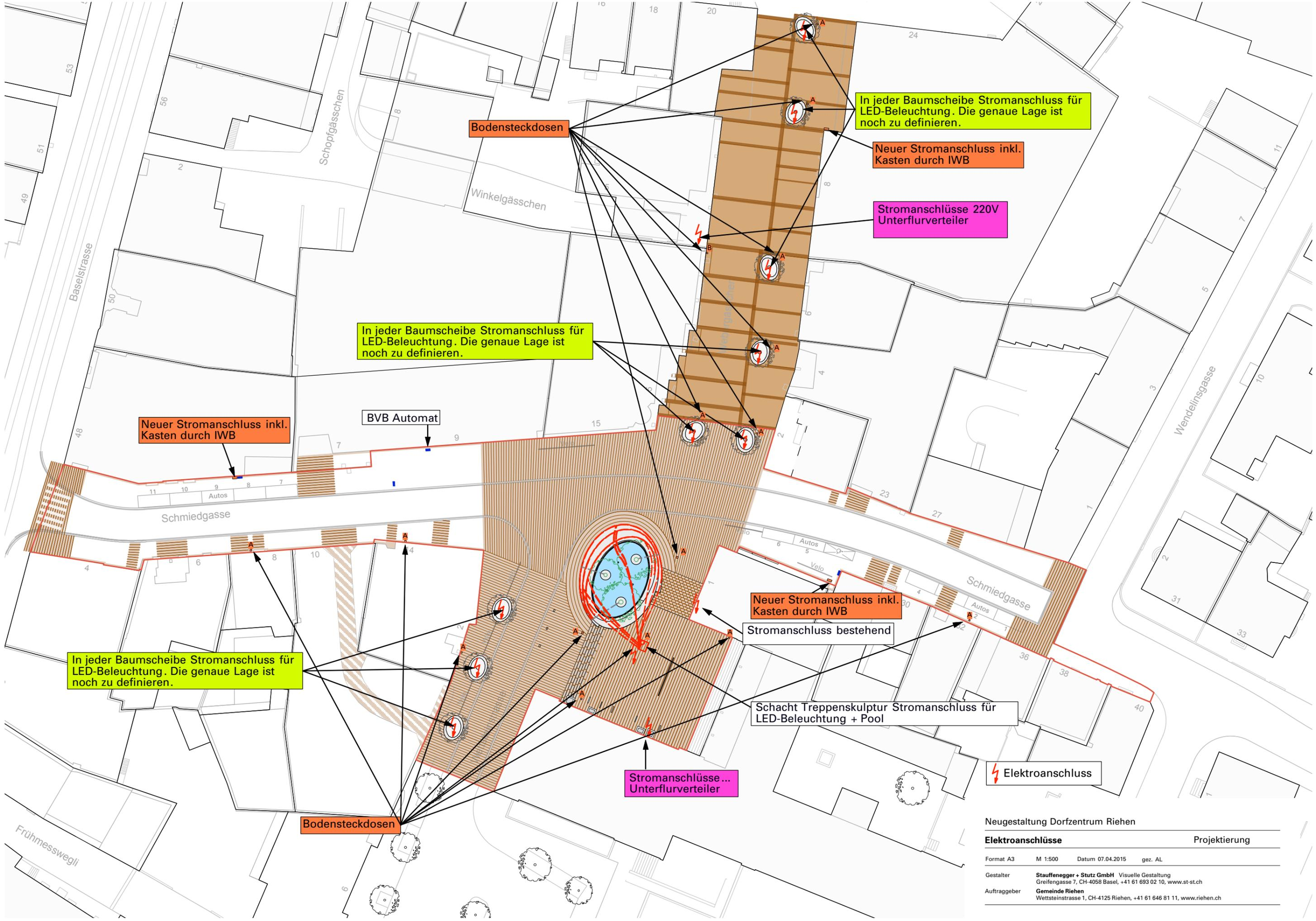
In jeder Baumscheibe Stromanschluss für LED-Beleuchtung. Die genaue Lage ist noch zu definieren.
