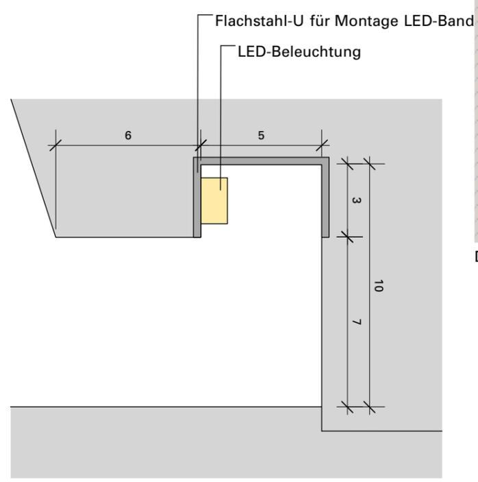
Detail A1 - Einbau Licht 1:2
