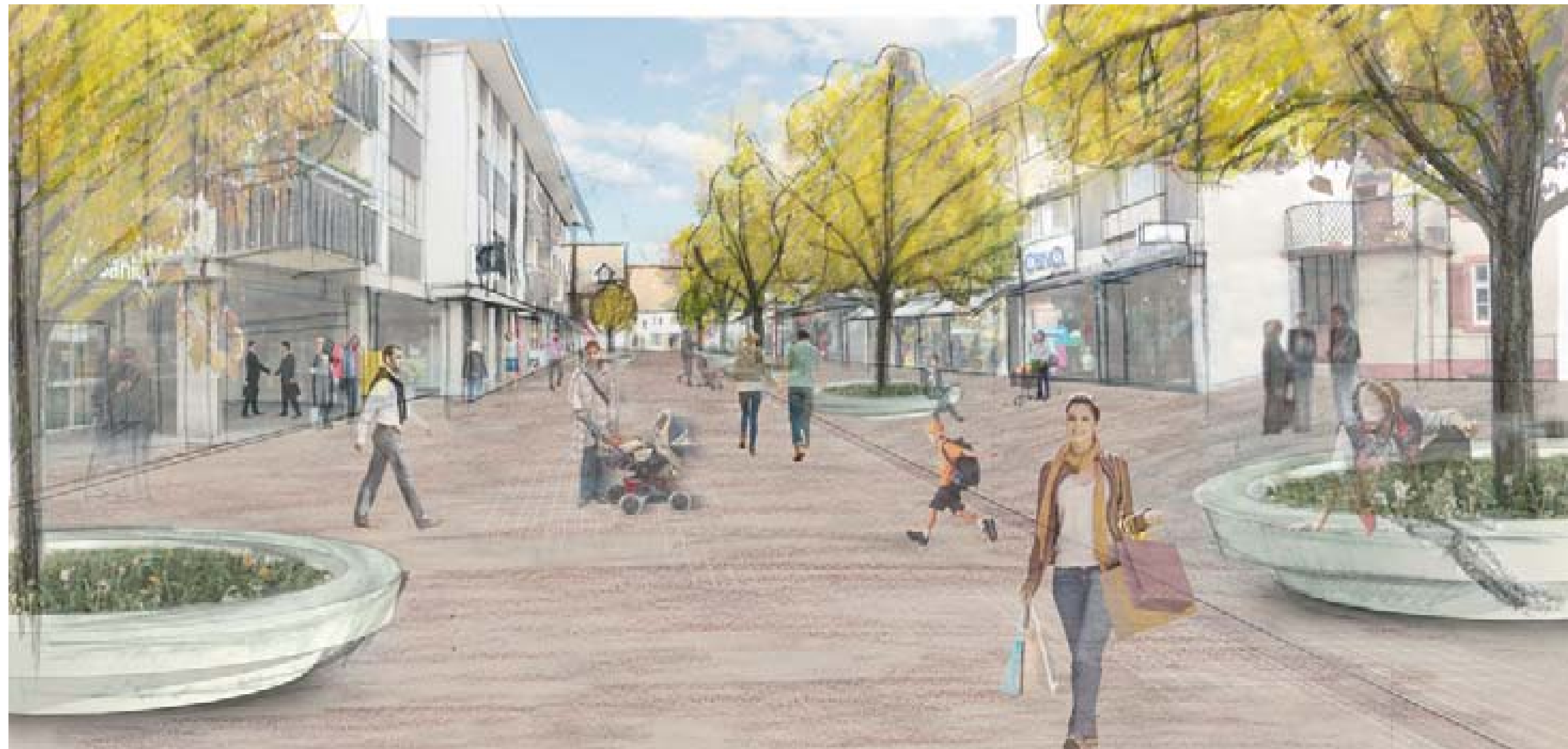
Im Webergässchen werden die bestehenden quadratischen Rabatten ersetzt. Die neuen Baumscheiben dienen den Passanten als Sitzgelegenheit. Der Natursteinbelag im Webergässchen bleibt bestehen.
